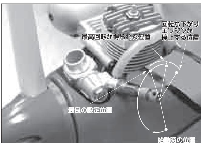
3) 電池を外した後、ニードルバルブの最終調整をします。
